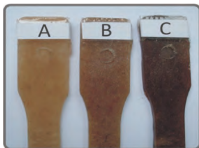
Figura 1: Amostras dos compósitos biodegradáveis utilizadas durante as entrevistas com os designers, A) 5% de fibra, B) 15% de fibra e C) 20% de fibra.
